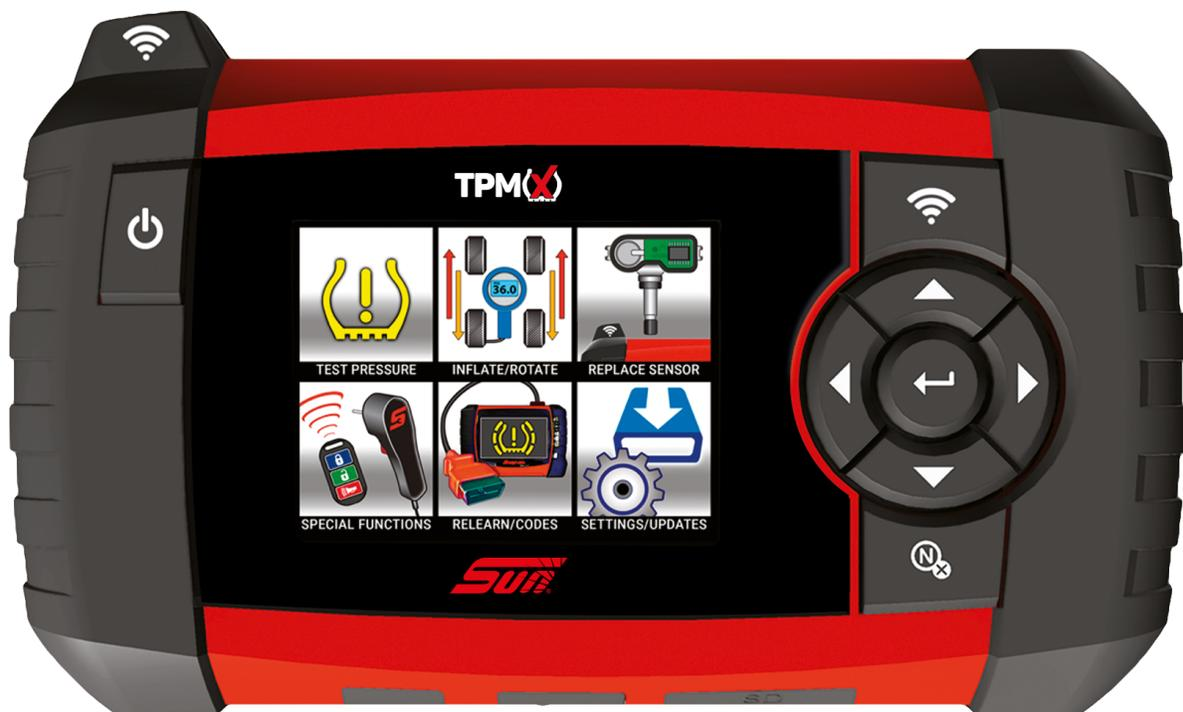
A ferramenta de diagnóstico TPMX é utilizada para testar os sensores de monitoramento de pressão dos pneus, coletar dados desses sensores e realizar o reaprendizado do sistema. Também configura sensores do paralelos e imprime informações contidas nos sensores. É o complemento perfeito para oficinas que possuem uma plataforma de diagnóstico SUN®.
