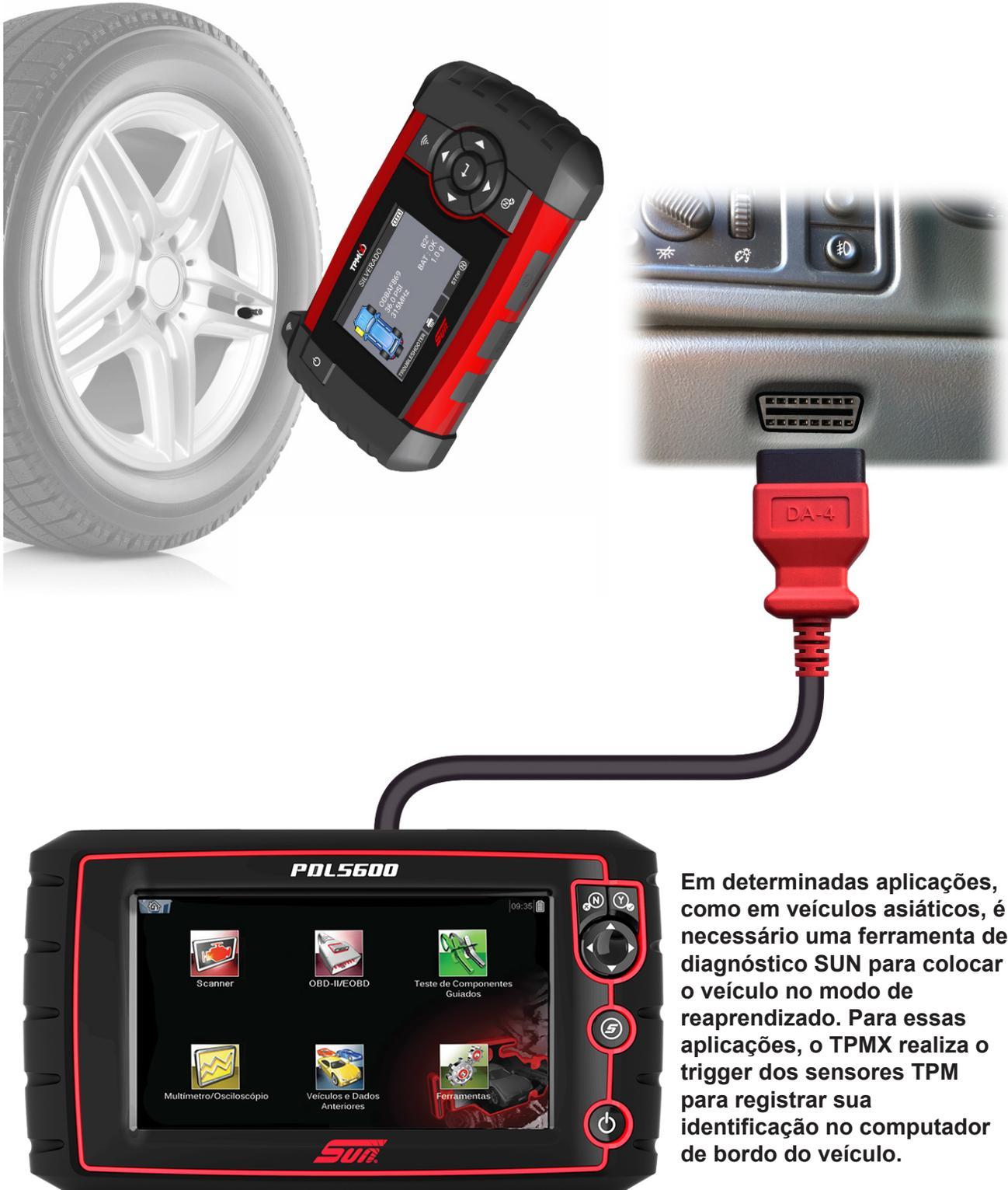
Em determinadas aplicações, como em veículos asiáticos, é necessário uma ferramenta de diagnóstico SUN para colocar o veículo no modo de reaprendizado. Para essas aplicações, o TPMX realiza o trigger dos sensores TPM para registrar sua identificação no computador de bordo do veículo.
