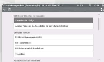
Varredura e limpeza de códigos com um toque, verificando e apagando códigos de todos os módulos do veículo.
